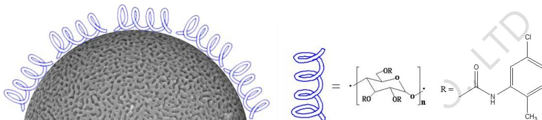
涂覆有直链淀粉-三（5-氯-2-甲基苯基氨基甲酸酯）的5μm硅胶填料
